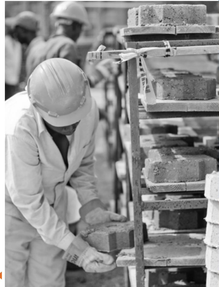
Des travailleurs fabriquant des briques de pavés à partir de débris recyclés.
