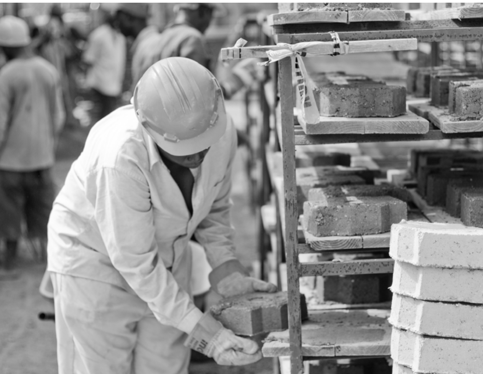
Des travailleurs fabriquant des briques de pavés à partir de débris recyclés. Démolition et enlèvement des débris avec de la machinerie lourde Photo courtoisie du FRH
